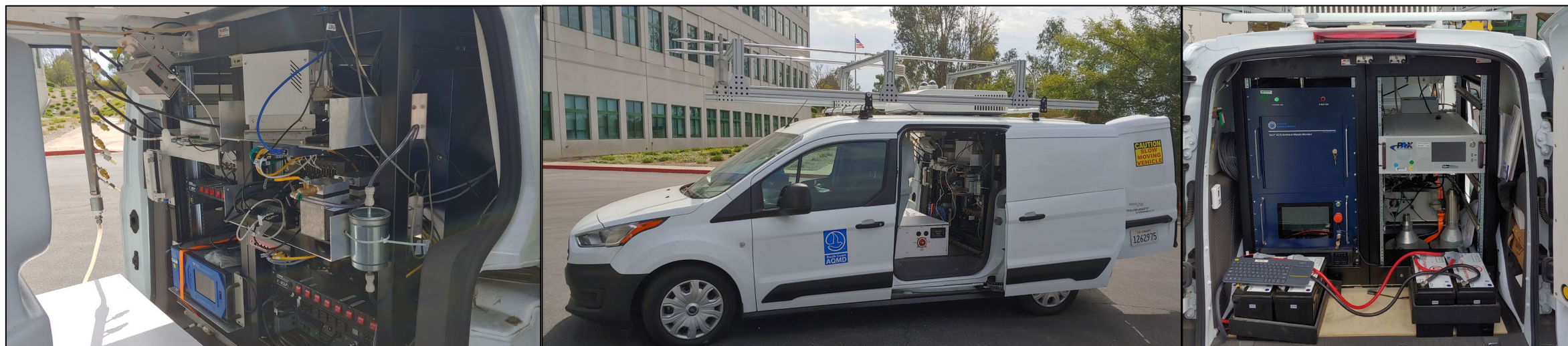
Plataforma Móvil de Multi-Metales (MMMP) desarrollada por South Coast AQMD
